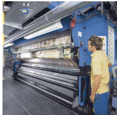
Rotogravura para publicações (revistas e catálogos) tem a vantagem de trabalhar com bobinas de até 4,32 metros de largura e sistema automático de produção.
