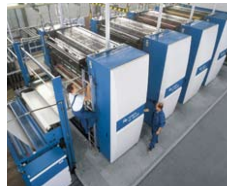
Na impressão offset rotativas comercial é possível atualmente imprimir até 80 páginas com bobinas com mais de 2 metros de largura
